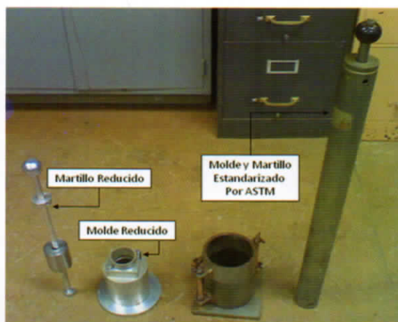
Figura 2 Comparación entre el Equipo de Compactación Estandarizado por la ASTM y el Equipo de Compactación Utilizado Durante esta Investigación (Reducido)
