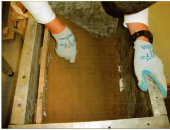
Figura 5 Proceso de Montaje del Modelo de Talud
