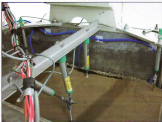
Figura 6 Instrumentación Modelo de Talud en la Centrifuga
