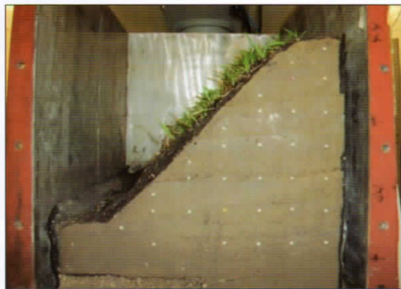
Figura 6 Instrumentación Modelo de Talud en la Centrifuga
