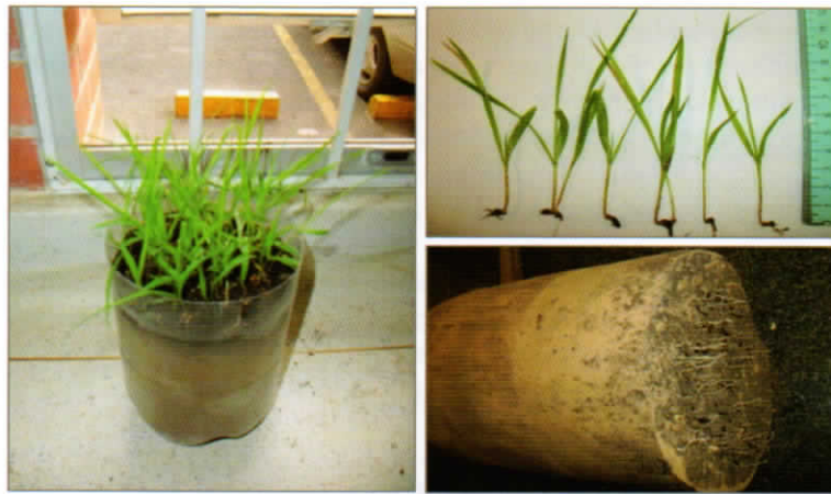
Figura 2 Muestra de Suelo con Raíces para el Ensayo de Corte Directo
