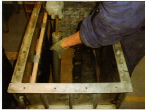
Figura 5 Proceso de Montaje del Modelo de Talud
