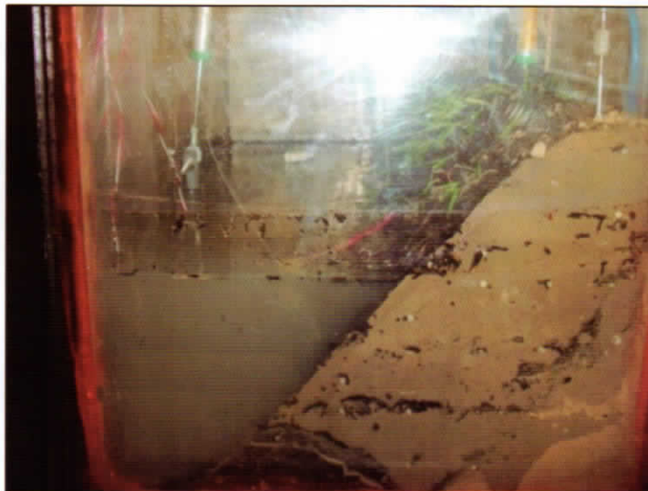
Figura 8 Condición Talud Sin Vegetación con Nivel de Agua a 30 cm
