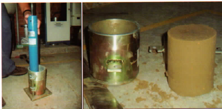
Figura 1. Método Empleado para Ensayo de Compactación
