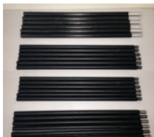
Figura 5. Fotografía barras extensoras de diferentes materiales, de arriba abajo, aluminio, acero, fibra de vidrio y fibra de carbono.
