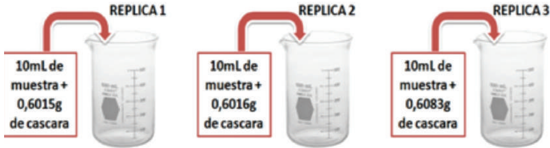
Figura 5. Reducción de los niveles de cromo a partir de la adición de cascara de naranja.
