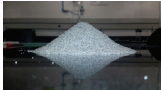
Figura 3. Vista montículo de arena ensayo de ángulo de fricción natural de reposo, arena del Guamo.
