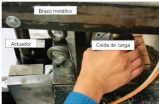
Figura 8. Montaje del sistema de carga en el modelo físico.
