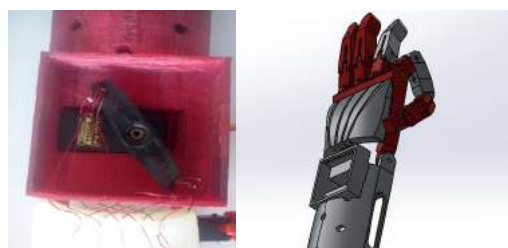
Figura 14. 14a. (Izquierda) Conexión cables con servomotor. 14b. (Derecha) Diseño final realizado en Solidworks.
