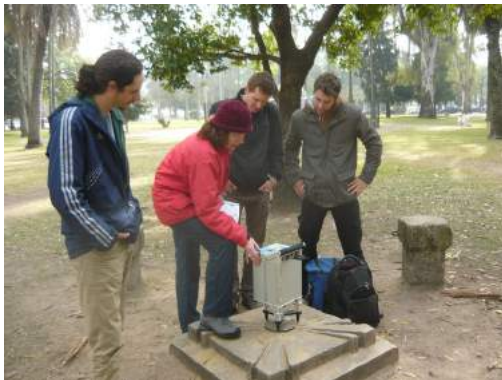
Figura 6. Medición con gravímetro absoluto Scintrex sobre el Nodal del Rosario
