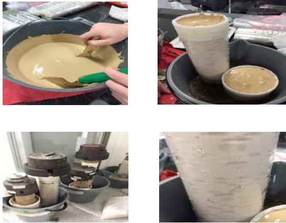
Figura 5. Etapas del proceso: Arriba Izquierda: Elaboración suelo al 1.5 LL, Arriba derecha Dsposición suelo en Acrílicos perforados, Abajo Izquierda: Proceso de carga, Abajo derecha: Eliminación de Agua. Fuente: Autores
