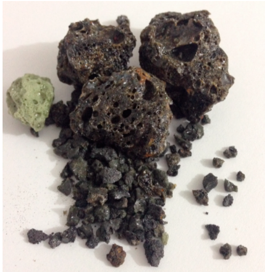
Figura 2. Escoria de Alto Horno Fuente: Autores.
