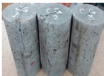
Figura 18: Resultados cilindros concreto con fibras de guadua. Fuente: (Autores, 2018)
