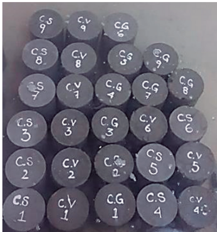
Figura 14: Curado cilindros en concreto.
