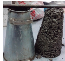
Figura 11: ensayo de asentamiento concreto con fibras de vidrio 1"
