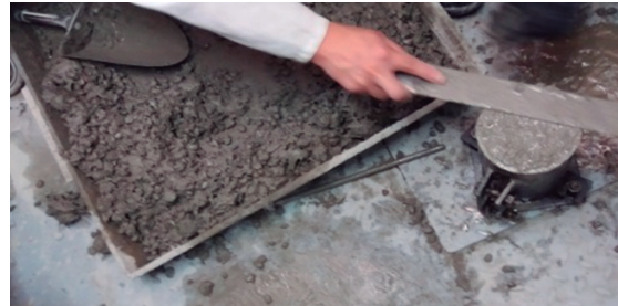
Figura 13: Llenado de moldes concreto con fibras de vidrio. Fuente: (Autor. 2018)
