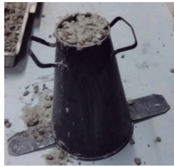
Figura 9: Ensayo de asentamiento concreto simple 1 1/2".
