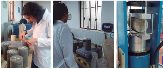
Figura 15: Proceso de ensayo a tracción indirecta Fuente: (Autores. 2018)
