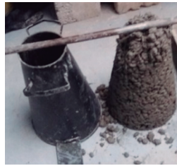
Figura 10: Ensayo de asentamiento concreto con fibras de guadua
