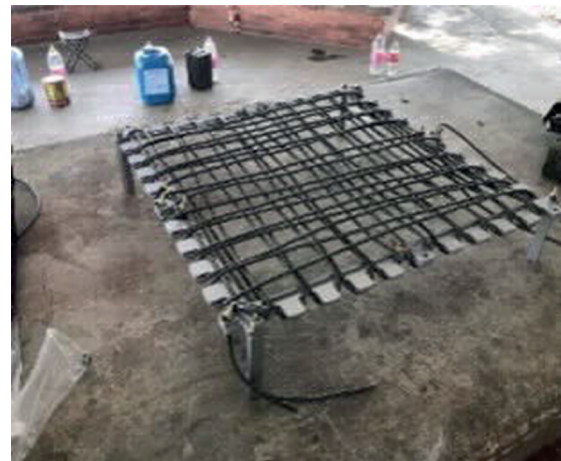
Figura 6. Proceso de construcción de la MCD 24 \times 24 pulgadas cuadradas. Fuente: elaboración propia.
