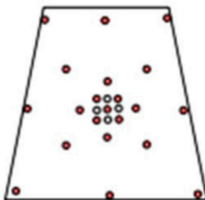
Figura 6. Diagrama de tiros inclinado 1. Método de Holmberg. Fuente: [16]
