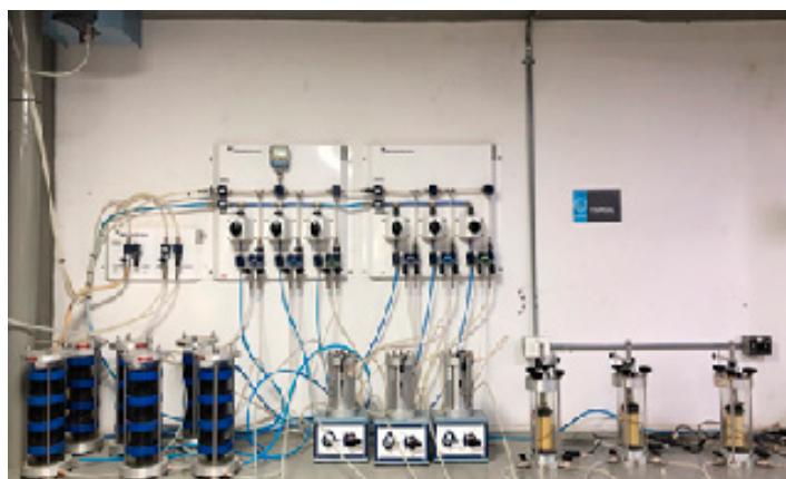
Figura 8. Sistema de presión y contrapresión del ensayo triaxial.
