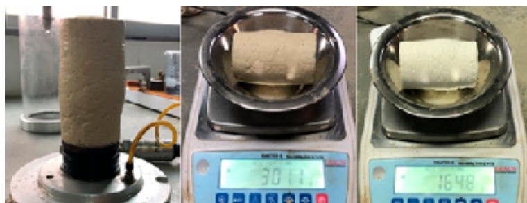
Figura 9. Desmonte y lectura de humedad final del espécimen.
