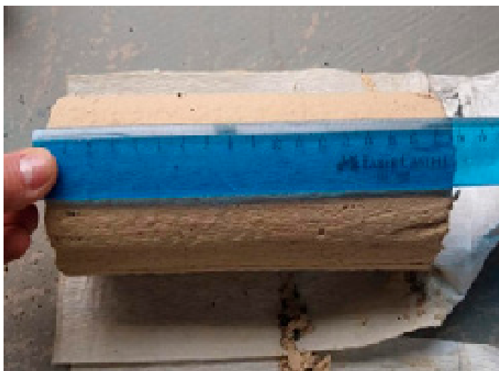
Figura 6. Extracción de las muestras luego de la preconsolidación inicial Fuente: autores del proyecto.
