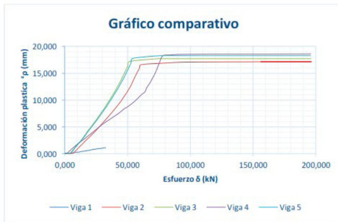
Figura 10. Gráfica esfuerzo-deformación probetas concreto y plástico. Fuente: autores del proyecto.
