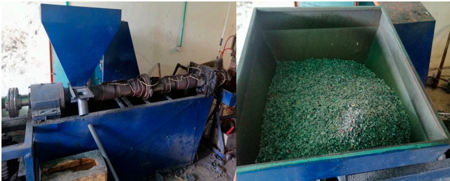
Figura 7. Zona y proceso de alimentación. Fuente: autores del proyecto.
