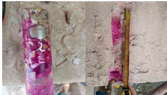
Figura 6. Determinación de profundidad de carbonatación en campo y laboratorio. Fuente: autores del proyecto.
